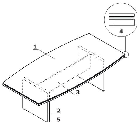
1. **Arbeitsplatte** - Melaminplatte 52 mm (12+12+28 mm), Umleimer ABS
