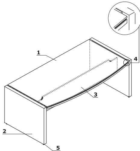
1. **Arbeitsplatte** - Melaminplatte 52 mm (12+12+28 mm), Umleimer ABS
