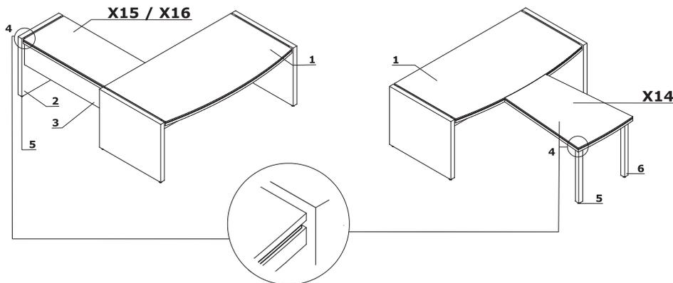
1. **Arbeitsplatte** - Melaminplatte 52 mm (12+12+28 mm), Umleimer ABS
